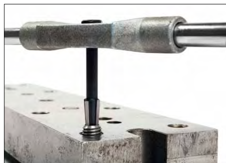
Закрепление экстрактора с помощью воротка Setting the extractor with a tap wrench
