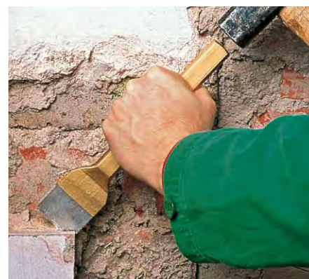
Зубило для стыков Jointing chisels
