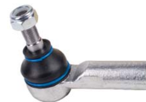
► Orj Ref : TYT29 Descr. : Tie rod end OEM No : 4504619175-4504629305 Note : M14*1.5 RHT
