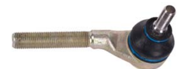
Orj Ref : PJ017-R Descr. : Tie rod end-R OEM No : 381742-381716-381731 Note : M14*1.5 RHT
