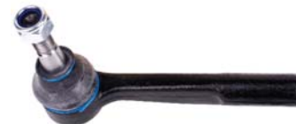
▶ Orj Ref : OP118-R Descr. : Tie rod end-R OEM No : 1603228-93172255 Note : M14*1.5 RHT
