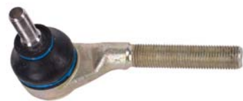
▶ Orj Ref : PJ017-L Descr. : Tie rod end-L OEM No : 381741-381714-381730 Note : M14*1.5 RHT
