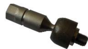
▶ Orj Ref : PJ190 Descr. : Axial joint OEM No : 3812E7-3812E3 Note :
