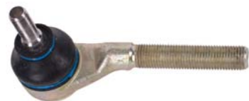
► Orj Ref : PJ017-L Descr. : Tie rod end-L OEM No : 381741-381714-381730 Note : M14*1.5 RHT
