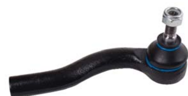
► Orj Ref : FI062-R Descr. : Tie rod end-R OEM No : 46456660-46745364 Note : M14*1.5
