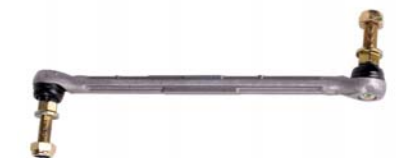
► Orj Ref : FR077 Descr. : Stabilizer link OEM No : 1106269-YS713B438AA Note : Aluminium
