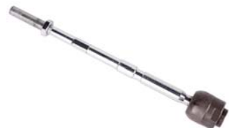
► Orj Ref : VOL36 Descr. : Axial joint OEM No : 1205666 Note : M14*2 RHT
