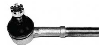
▶ Orj Ref : NS053 Descr. : Tie rod end OEM No : 4852031G25-485207F000 Note : M16*1.5 R / -1992
