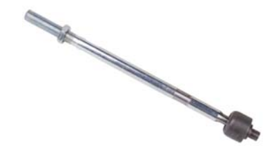
► Orj Ref : FR049 Descr. : Axial joint OEM No : 3903147-7294415-6737692-F5RC3280BA Note : M16*1.5 / L=336 mm
