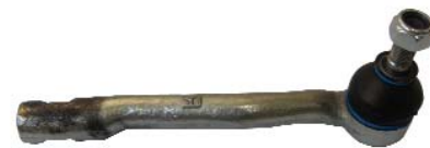
► Orj Ref : TYT21-R Descr. : Tie rod end-R OEM No : 4504629275-4504629335 Note : M14*1.5 RHT
