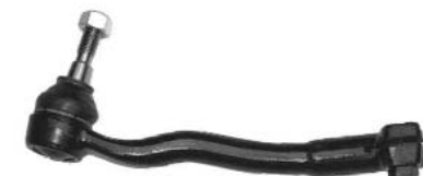
Orj Ref : BMW43-L Descr. : Tie rod end-L OEM No : 32211091723 Note : M16*1.5 RHT
