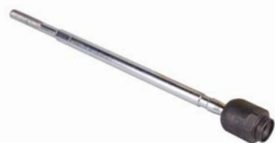
► Orj Ref : SK030 Descr. : Axial joint OEM No : 115500420-6U0422807-007350278N Note : M12*1 RHT
