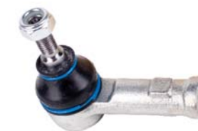
► Orj Ref : HD018 Descr. : Tie rod end OEM No : 5682025000-5682037000 Note : M14*1.5 RHT
