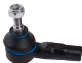
► Orj Ref : PJ058 Descr. : Tie rod end OEM No : 405909-9404059080 Note : M14*1.5 RHT
