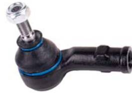
► Orj Ref : FR050-R Descr. : Tie rod end-R OEM No : 1020174-1011857-1E0032280A-96FB3289AC Note : M14*2
