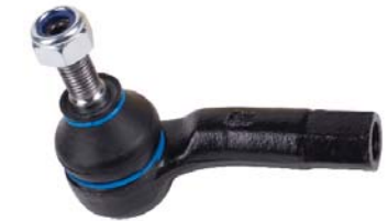
▶ Orj Ref : SE002-R Descr. : Tie rod end-R OEM No : 6Q0419812-6Q0423812A-6Q0423812C Note : M14*1.5 RHT
