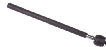
▶ Orj Ref : PJ019 Descr. : Axial joint OEM No : 381292 Note : M14*1.5 RHT / L=355 mm
