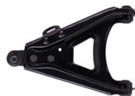
► Orj Ref : DA147-R Descr. : Lower control arm complete-R OEM No : 6001538335 Note :
