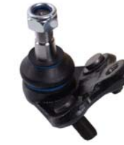
► Orj Ref : TYT16 Descr. : Ball joint OEM No : 4333039265-4550329375 Note : Lower
