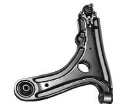
▶ Orj Ref : VW021-R Descr. : Lower control arm complete-R OEM No : Note : Ø19 mm
