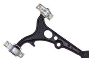
► Orj Ref : FI102-R Descr. : Lower control arm complete-R OEM No : 46423823-82461082-7777240 Note : Forging - 17mm
