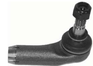
▶ Orj Ref : AU042-R Descr. : Tie rod end-R OEM No : 443419812D-443419812B Note : M16*1.5 RHT
