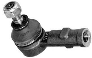
► Orj Ref : VOL31 Descr. : Tie rod end OEM No : 3516944-1205658 Note : M14*2 RHT
