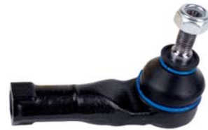
▶ Orj Ref : RN202-R Descr. : Tie rod end-R OEM No : 7701047416-7701047813-7701475842-7701474642-7701474493 Note : M14*1.5
