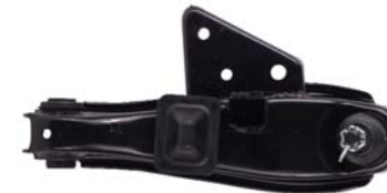
► Orj Ref : HD049-L Descr. : Lower control arm complete-L OEM No : 545104B000 Note : Pick Up
