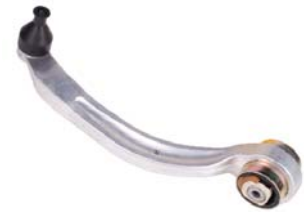
Orj Ref : AU026-R Descr. : Control arm-R OEM No : 4D0407694N-8E0407694E-4D0407694H-4D0407694K-4D0407694E Note : Front / Lower
