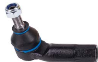
▶ Orj Ref : VW079-L Descr. : Tie rod end-L OEM No : 1K0423811A-1K0423811E Note :
