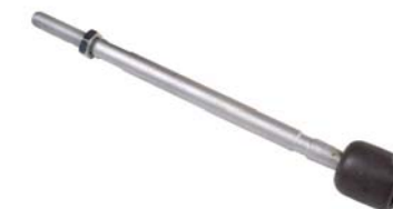
► Orj Ref : VOL39 Descr. : Axial joint OEM No : 3293736 Note : M14*1.5 RHT
