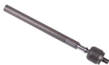
▶ Orj Ref : PJ043 Descr. : Axial joint OEM No : 381219-381215 Note : M14* 1.5 / L=262 mm
