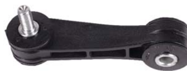
► Orj Ref : VW011 Descr. : Stabilizer link OEM No : 1J0411315C-1J0411315J Note : Plastic
