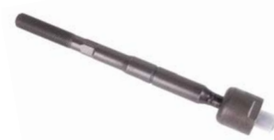
► Orj Ref : TYT22 Descr. : Axial joint OEM No : 4550329615-45503229435 Note : M14*1.5 RHT
