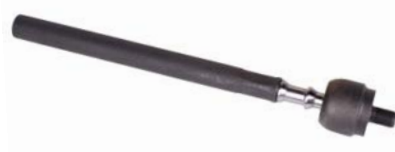
▶ Orj Ref : RN205 Descr. : Axial joint OEM No : 7701465159 Note : M14*1.5
