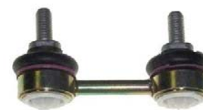
▶ Orj Ref : AU002 Descr. : Stabilizer link OEM No : 4A0505389 Note : Rear
