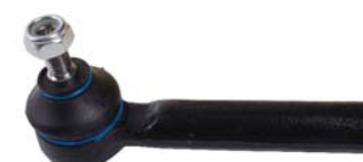
► Orj Ref : FI008 Descr. : Tie rod end OEM No : 5958246-5958247-5983404-5983406-7560331 Note : M12*1.5/L=127m
