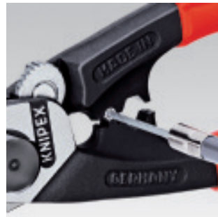
напрессовка концевой гильзы на тяговый трос
