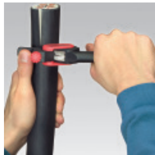
Вращение инструмента для разреза по окружности
