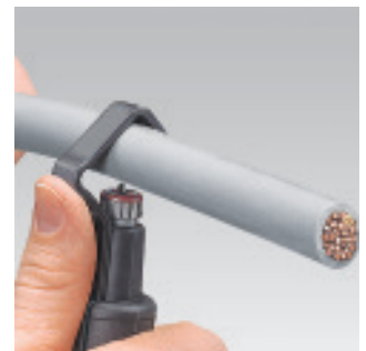
Установка инструмента для разреза по окружности
